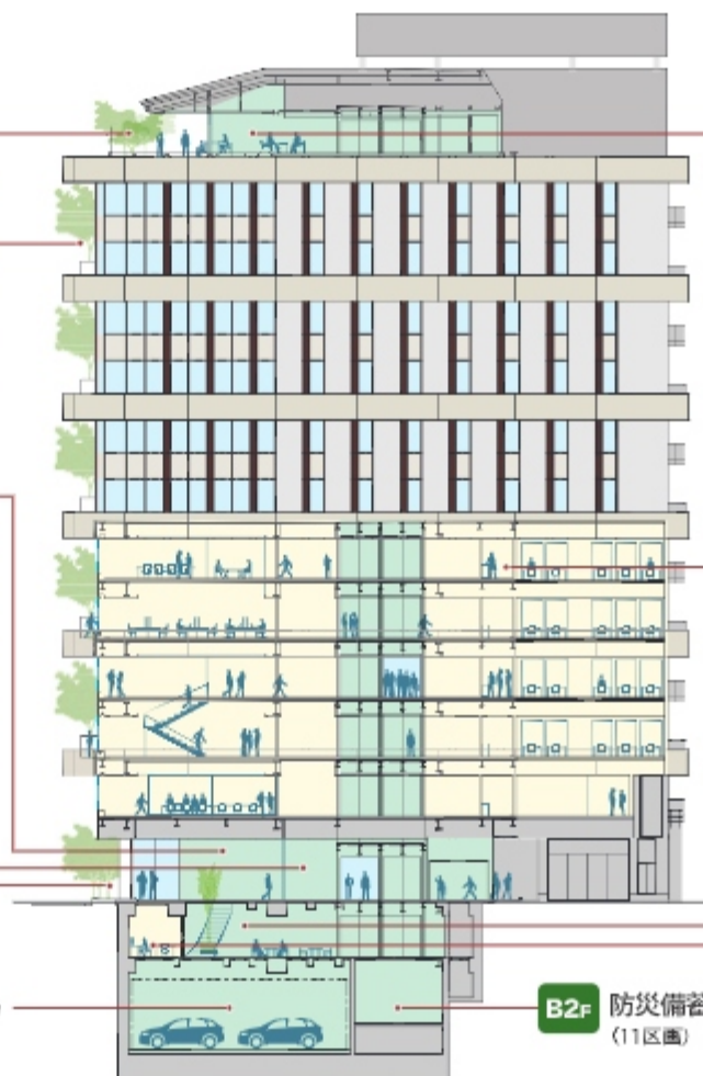
B2F 機械式駐車場
