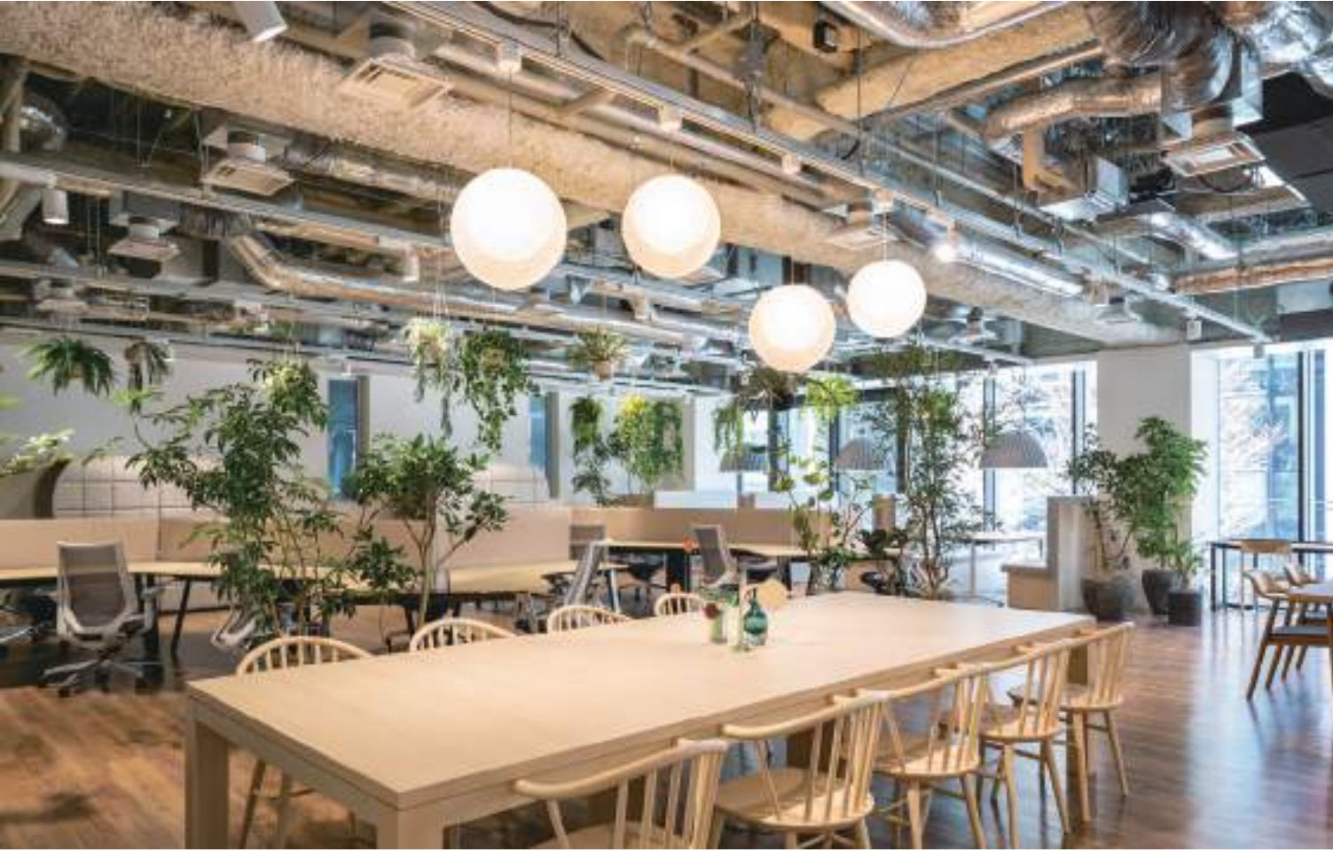
スケルトン天井により最高高さ3,700mmを確保。スタイリッシュなデザイン性と開放感のある空間を実現します。(2階LIVE OFFICE/2021年2月撮影)
